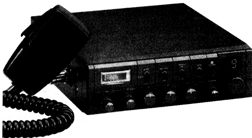
Obr. 45. Základnová radiostanice ALAN 87 s mnoha ovládacími prvky
