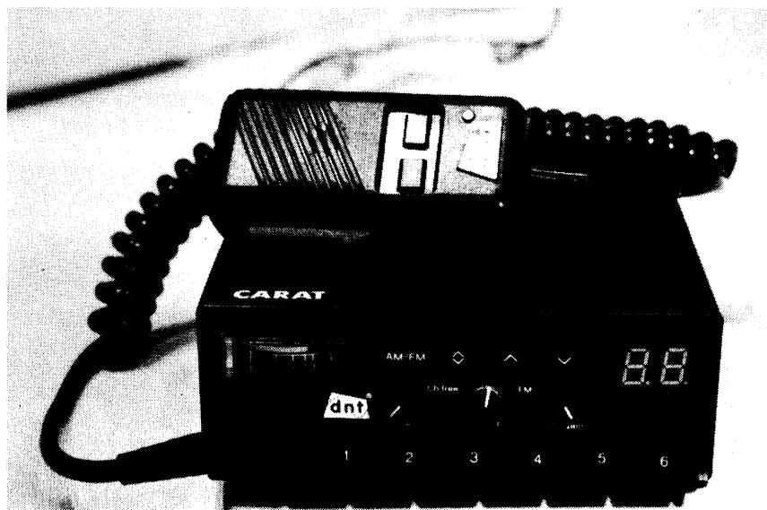
Obr. 42. Radiostanice DNT CARAT vybavená umlčovačem šumu v režimu AM
